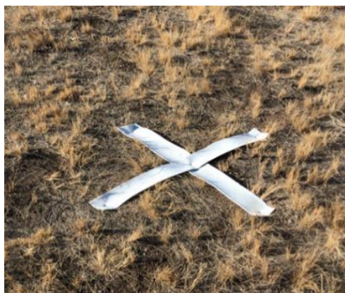
Рисунок 7- Опознак для проведения аэрофотосъемки
